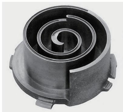
傳統渦卷式壓縮機在旋轉壓縮時容積效率只能保持相同，三菱重工改變了上方與底部渦流板設計(如上圖所示)，此時當冷媒在旋轉壓縮時容積效率可變，不僅提升壓縮效率更可增加冷凍效率，R404A冷煤量也與以往TD系列節省了56%。
