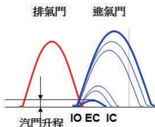
低升程：通過提前關閉進氣門減少進氣泵損失(因為汽門提早關閉，可以減少因低速歧管產生的真空，使活塞受到了限制，產生泵損失)
